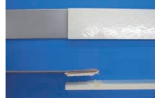
FRPとステンレスをPW Iで接着させた試験片
