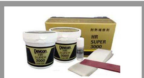
蒸気配管や給油管の漏れ止め、熱交換器、ボイラー等の腐蝕部やクラックの補修など、高温箇所の補修に最適で、発泡することなく短時間で補修ができます。熱を受け続けた場合にも劣化は少なく、付属のガラステープ(ガラスクロス)を併用することで強度が更にアップします。
