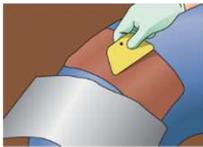
補修箇所貼り付けます。ファイバーガラスの下に空気が入り込まないように、中央から外側に向けてヘラでのばします。
