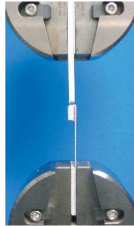
FRPのゲルコート面、バック面は基材破壊
