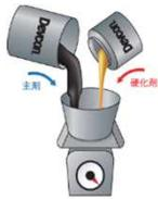
主剤と硬化剤を混合比率(重量比)に従って正確に秤で計量します。
