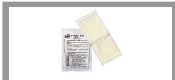
低粘度で流動性に優れた液状の樹脂が、2~4時間後には粘着性に富み、電気絶縁性に優れた耐水性のある軟質な寒天状の固形物に変化します。硬化後はテストターなどの棒状のものを突き刺してもその穴は塞がり、また簡単に手で引き剥がすことができますので、封止したものを簡単に取り出すことができます。
