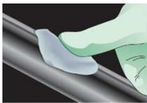
補修箇所に押し付けるように貼り付けます。
