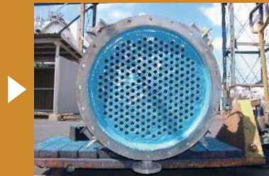
補修 ブラッシュアップセラミックとセラミックリペアーを使用して、チューブ式熱交換器管板面の恒久的な補修ができる。
