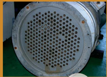
補修 ブラッシュアップセラミックとセラミックリペアーを使用して、チューブ式熱交換器管板面の恒久的な補修ができる。
