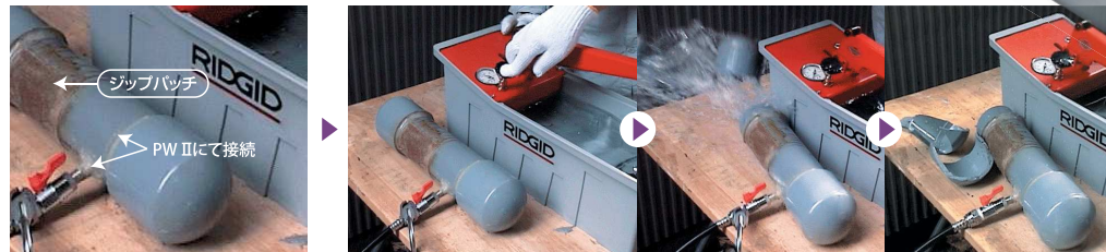
ジップパッチ耐圧試験。バルブと塩ビのジョイント部と塩ビキャップの接合にはデブコンPW IIを使用しています。
