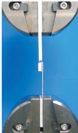
FRPのゲルコート面、バック面は基材破壊
